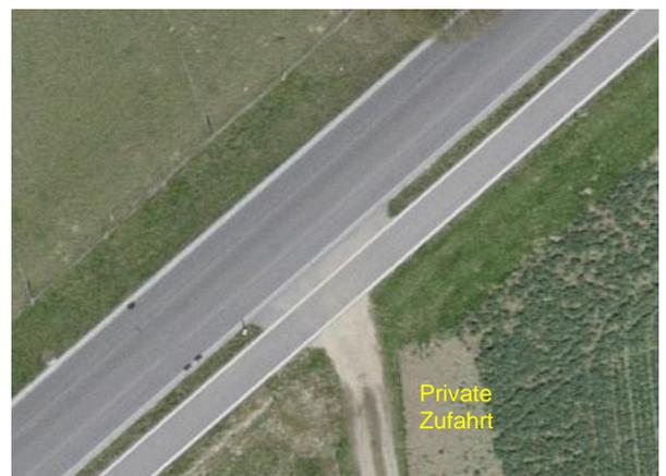
Abb. Nr. 13: Auszug AGIS, Beispiel durchgezogene Linie in Knotenbereichen mit Einmündung von privaten Zufahrten und beidseitiger Randmarkierung
